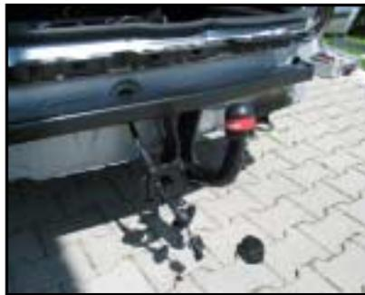
Anschluß des E-Satzes, Kabeldurchführung
