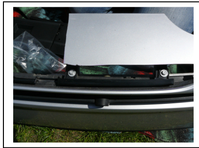
Halter für Diffusor montieren (li/re) (Schrauben und Muttern liegen bei)
